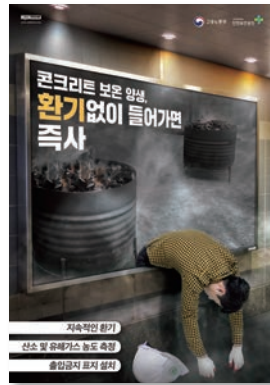
▲ 콘크리트 보온양생, 환기없이 들어가면 즉사
